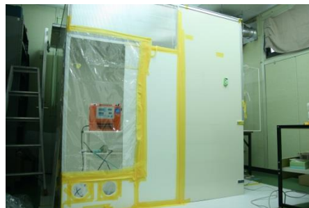
(図-4) 約 7m 3 の燻蒸試験ボックス
